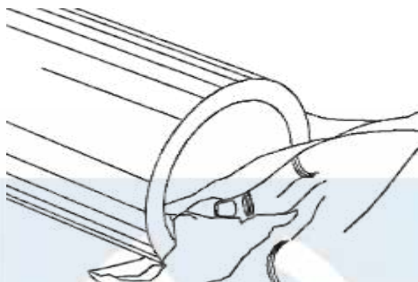
FIGURA C.4. Limpieza de la tubería
